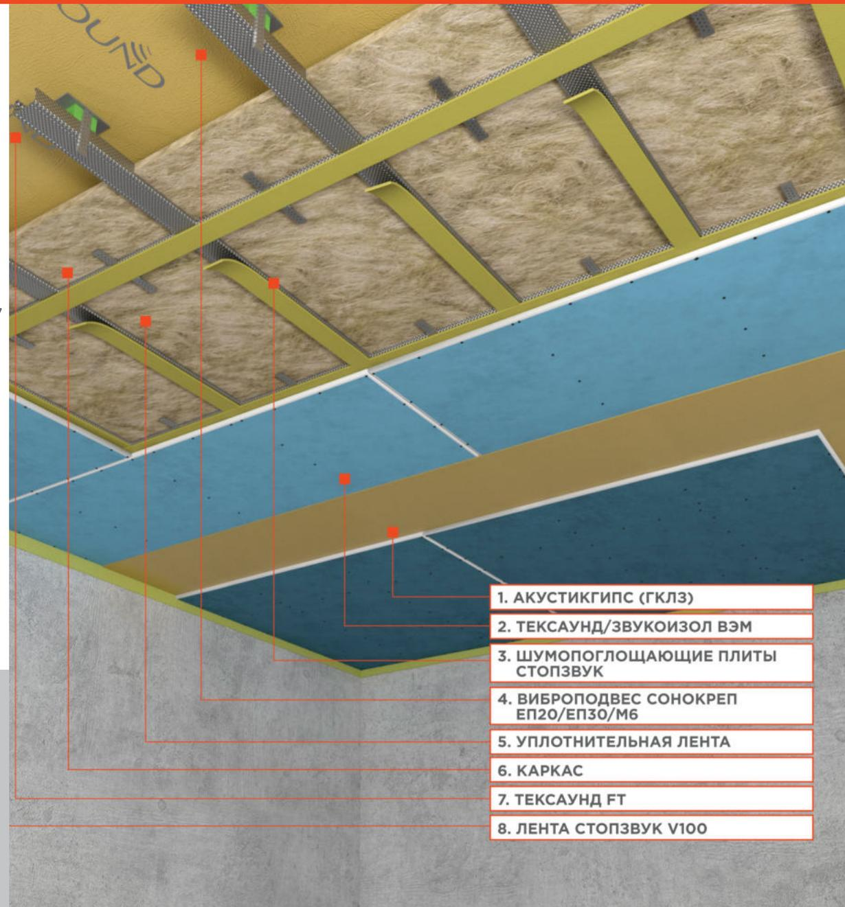
\* В состав системы не включены фиксирующие крепежные элементы для виброподвесов. Фиксирующие крепежные элементы подбираются самостоятельно в зависимости от состава основания потолка, функциональности помещения и требованиям к безопасности.
