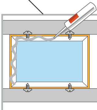
Наклеиваем уплотнительную ленту DB на поверхность профиля, заполняем пространство шумопоглощающими плитами.
