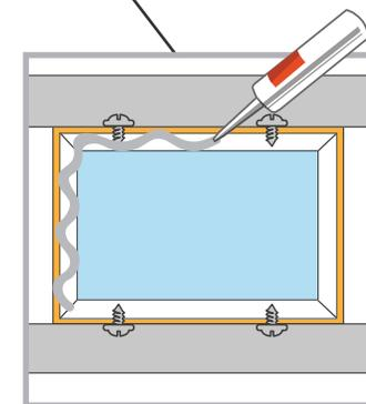
Устанавливаем Подрозетник АкустикГипс Бокс в заранее подготовленный каркас из профиля.
